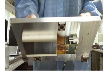
DSSD jig holding DSSD sensor
