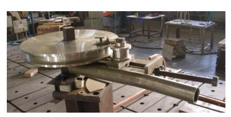
**Conductor bending machine**
