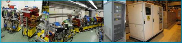
1) Dipole magnets 2)Vacuum chambers(TL2), 3)20kW SSPA- CLIC 4)100kV modulator- Linac4
