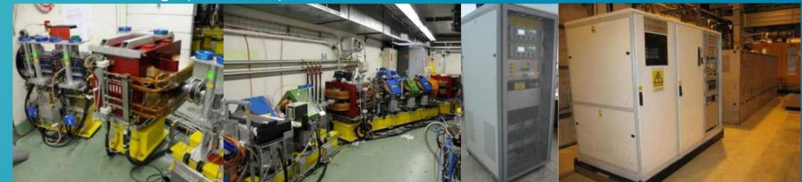
1) Dipole magnets 2)Vacuum chambers(TL2), 3)20kW SSPA- CLIC
